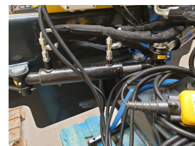
Stempel som påvirkes af controlleren (højre/venstre sving)
