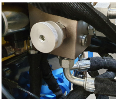
Flowcontroller som kontrollerer hastighed på fræserhovedet.
