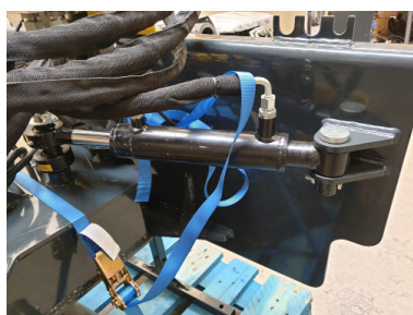
Stempel som påvirkes af controlleren (højre/venstre sving)
